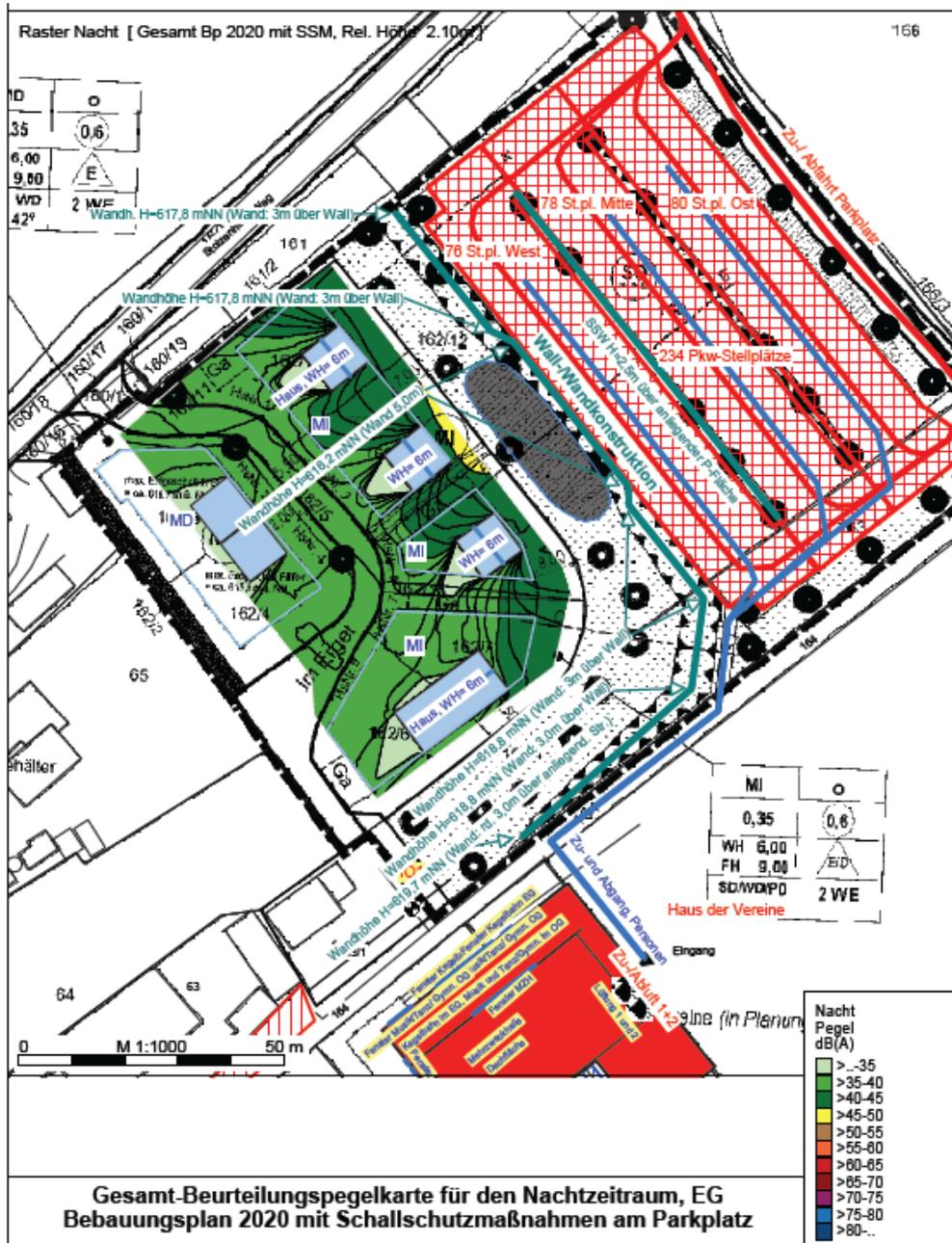
Lärmkarte Anlage 3.2 der Schalltechnischen Untersuchung: Immissionssituation in 4,80 m Höhe
