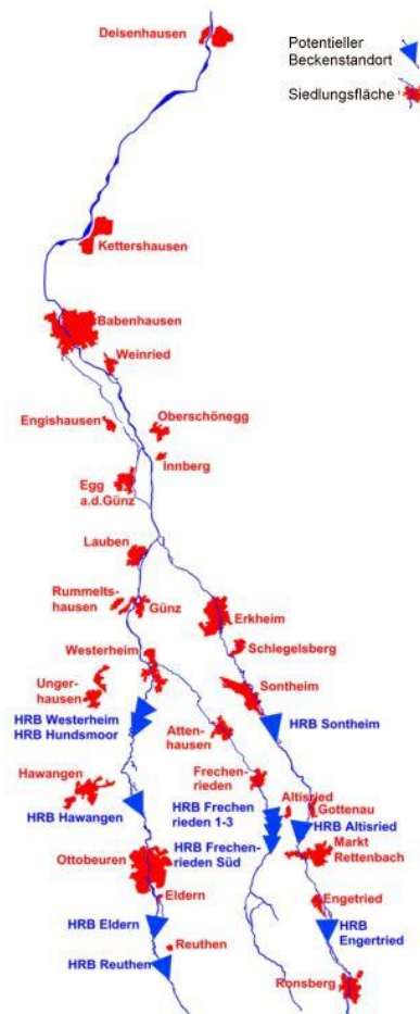
Abb. 7 Technischer Hochwasserschutz entlang der Günz (Wasserwirtschaftsamt Kempten)
