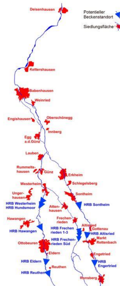
Abb. 7 Technischer Hochwasserschutz entlang der Günz (QInt15)
